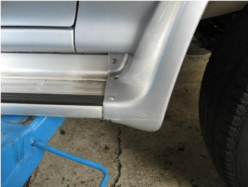
Bild:31 Radlaufverkleidung vr verschrammt
