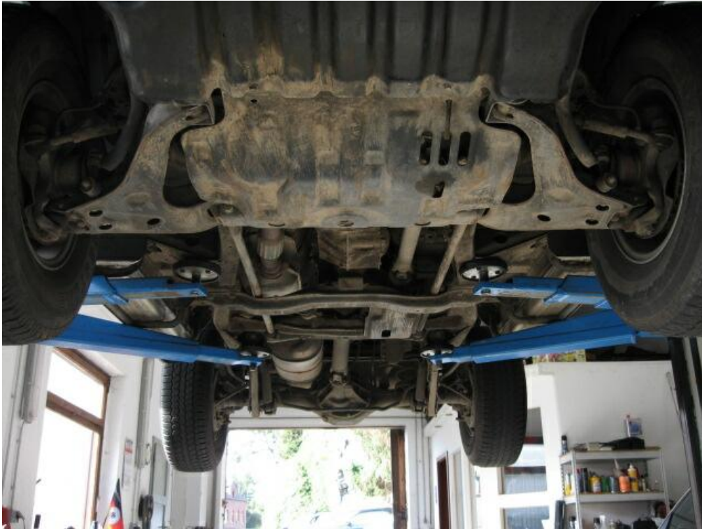
Bild:23 Fahrzeugunterboden: Einsatzbedingt verschmutzt
