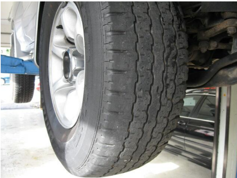
Bild:22 Reifen vorne im Schulterbereich stark verschlissen
