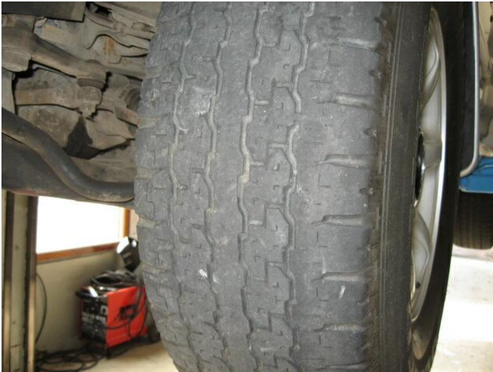
Bild:21 Reifen vorne im Schulterbereich stark verschlissen
