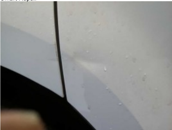
Beschädigung 3: Tür hinten rechts: Tür - Delle / Lackschaden - instandsetzen und lackieren
