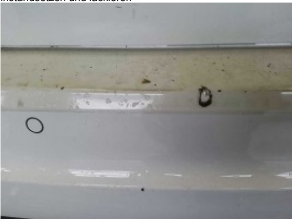
Beschädigung 5: Stossfänger hinten: Stossfänger hinten - Delle / Lackschaden - instandsetzen und lackieren
