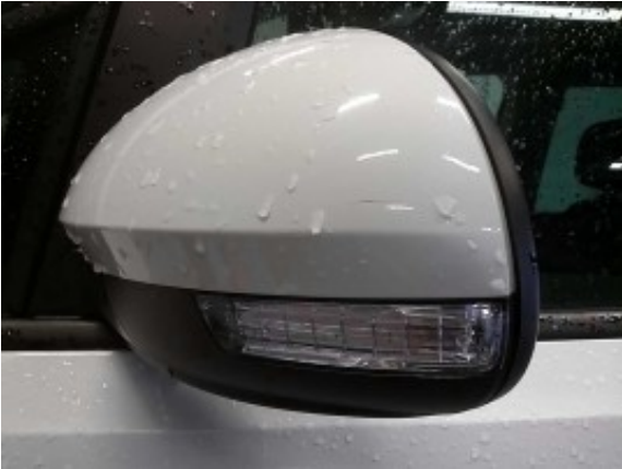
Beschädigung 1: Außenspiegel links: Abdeckkappe - Kratzer - Smart Repair
