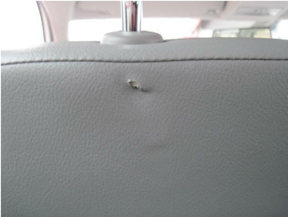
Bild:13 Fahrersitzlehnenbezug an Rückseite eingerissen
