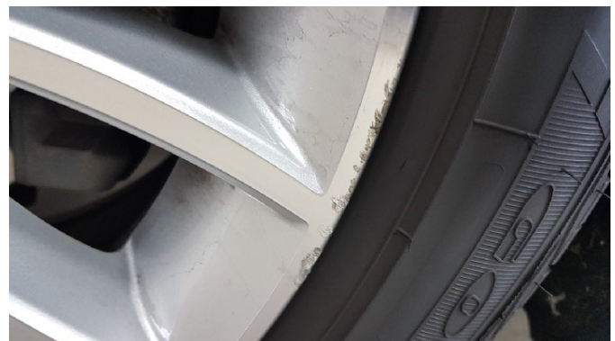
Bild 10: Felge Vorn Links - Verschrammt (Foto 2 )
