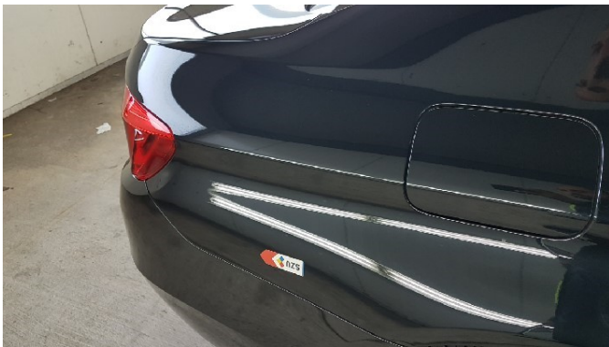
Bild 3: Seitenwand Rechts - Delle (Foto 1 )
