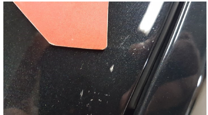
Bild 6: Motorhaube - Lackbeschädigung (Foto 2 )
