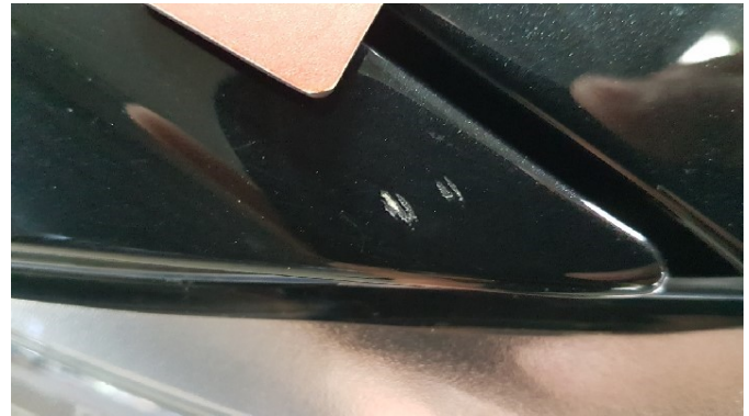
Bild 8: Kotflügel Rechts - Lackbeschädigung (Foto 2 )
