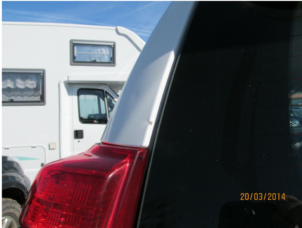
Bild 11: C-Säule, leicht eingedrückt, Lackschaden
